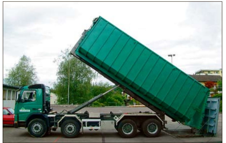
Ähnlich wie im Bild würden auch in Hitzkirch die Holzschnitzel mit Lastwagen in die unterirdische Heizzentrale gekippt.
